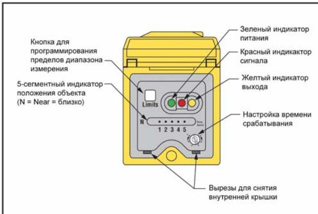
Рис. 1. Панель контроллера Q45UR с аналоговым выходом
