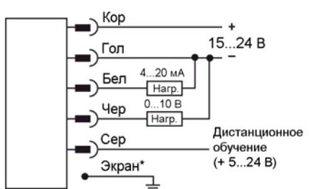
\* Провод экрана рекомендуется подключать к земле или общему проводу питания
