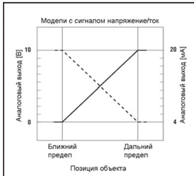
Рис. 3. Зависимость выходного сигнала от расстояния
