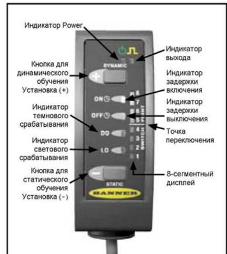
Рис. 1. Вид панели датчика
