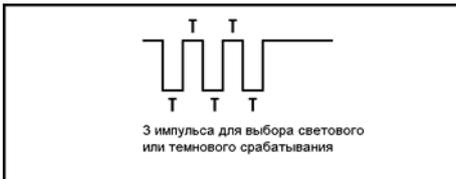
Рис. 5. Выбор светового или темного срабатывания
